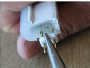
**Einsetzen der Kontaktleiste**: Im Querschnitt sind nun die 2 Kabel (bei RGB 4 Kabel) sichtbar. Nun wird die Kontaktleiste mit den gezackten Polen genau auf die Kabel positioniert und anschliessend mit einer Zange in das Neon-Flex hineingedrückt.
