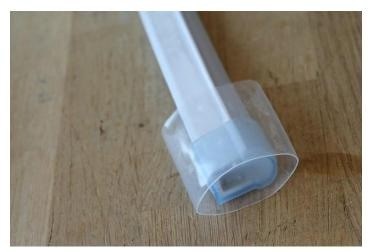
**Schrumpfschlauch:** Schrumpfschlauch mittig positionieren.
