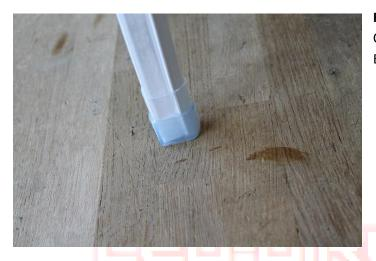
**Fertig**: Nach dem Abschrumpfen das Ende auf ein flache Oberfläche für ca 20 Sekunden andrücken, damit das Ende kantig wird.
