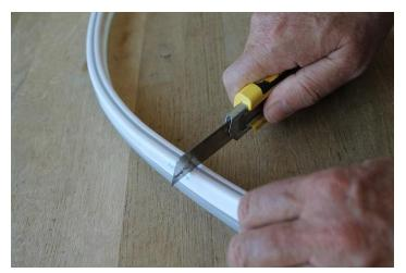
Ablängen der LED Neon-Flex Bänder: Die Neon-Flex Bänder werden mit einem Cutter auf die gewünschte Länge geschnitten. ACHTUNG: Es darf nur bei den Markierungen geschnitten werden. Andernfalls wird dieses Segment nicht mehr leuchten, da es unterbrochen ist.
