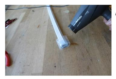
**Schrumpfen**: Schrumpfschlauch mit Heissluftföhn abschrumpfen.
